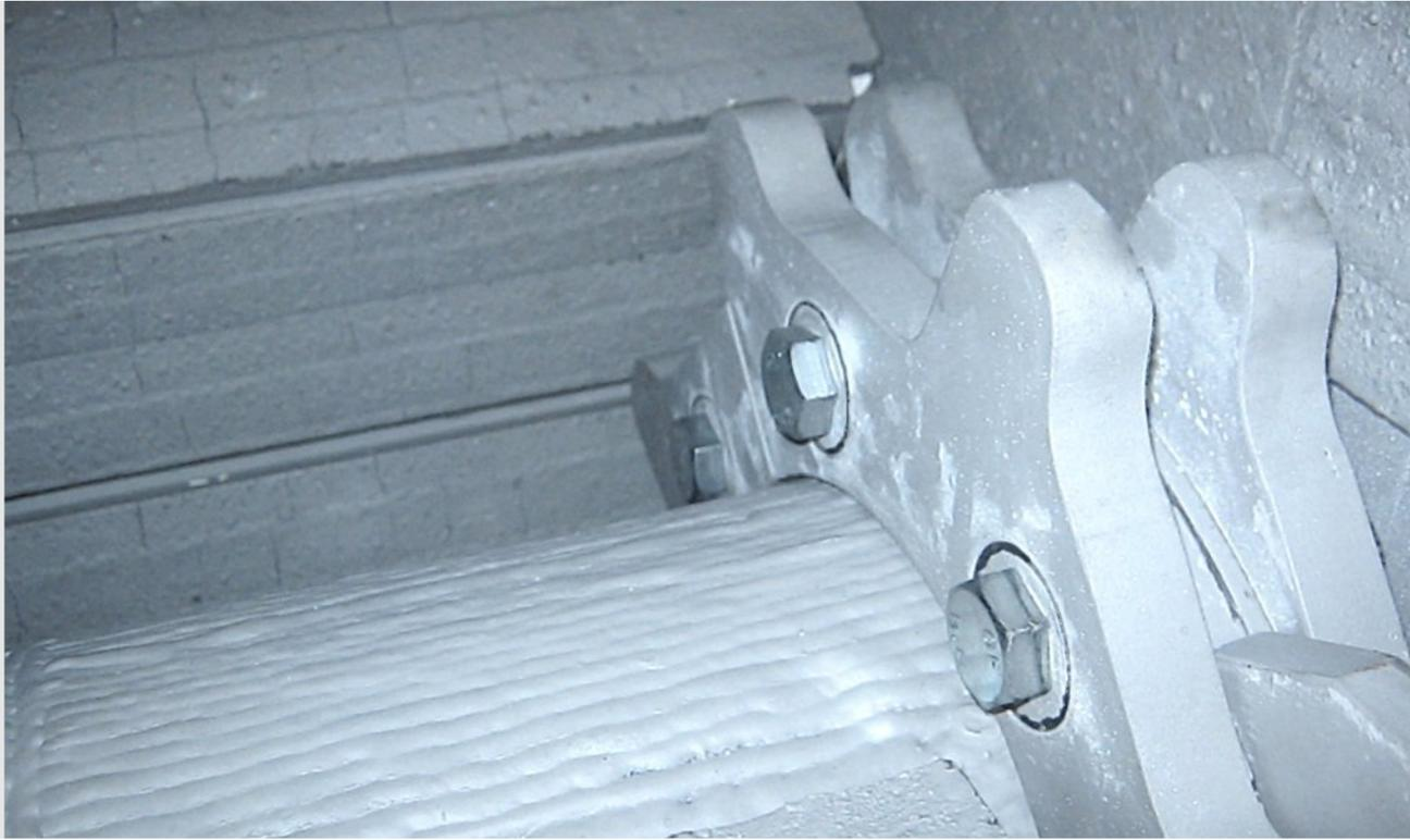
Materialumführung und Welle mit Verschleißschutz
