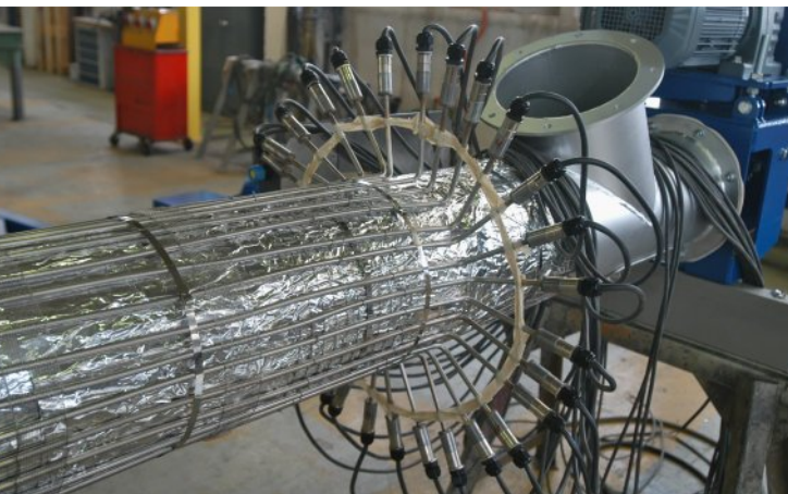
Endmontage Rohrschnecke mit elektrischer Begleitheizung
