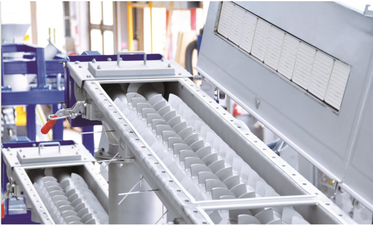
Doppelwellenmischer - in der Abdeckung installierte Heizstrahler
