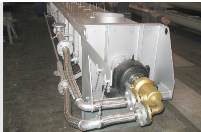
Heizmittel-Zufuhr über Drehdurchführung
