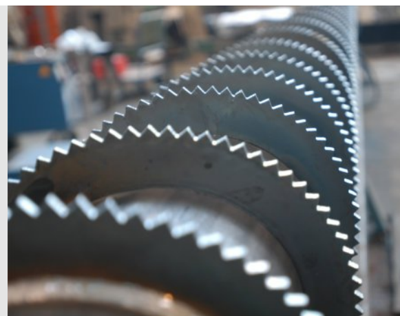
Schneckenwelle mit gezahnten Flügeln
