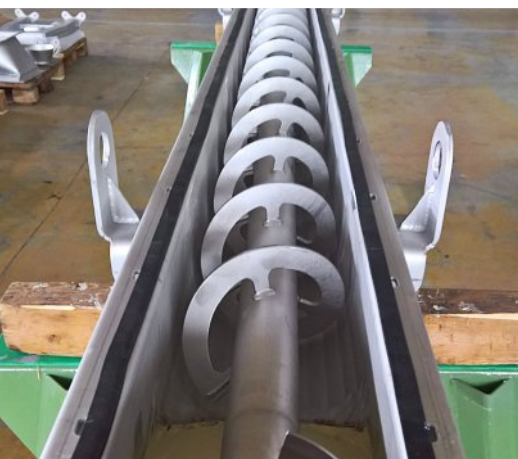
Trogsschnecke mit Bandspirale
