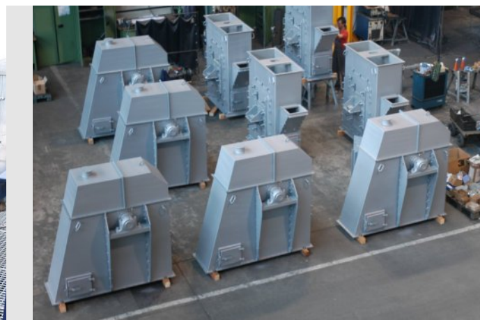
Endmontage Becherwerksköpfe und -füße
