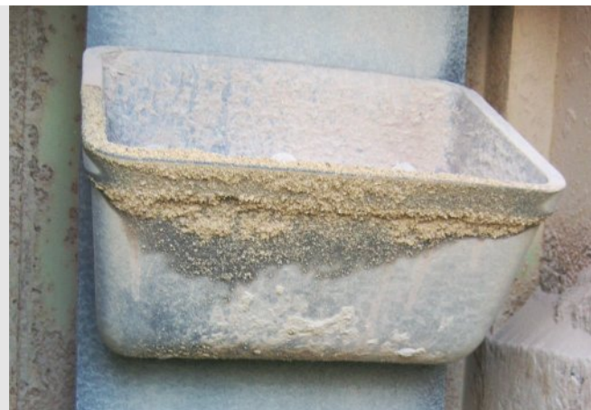
Gusspolyamidbecher nach jahrelangem Einsatz für Kies-/Sandförderung
